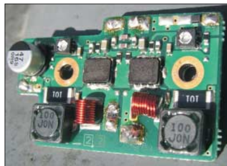
Bild 2: Die gesamte FT-817-Endstufenplatine final unit misst nur 2 cm × 4 cm. Fotos: OE3MZC
