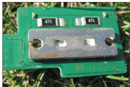
Bild 1: Detailaufnahme des Kühlblocks mit den eingelöteten Transistoren
