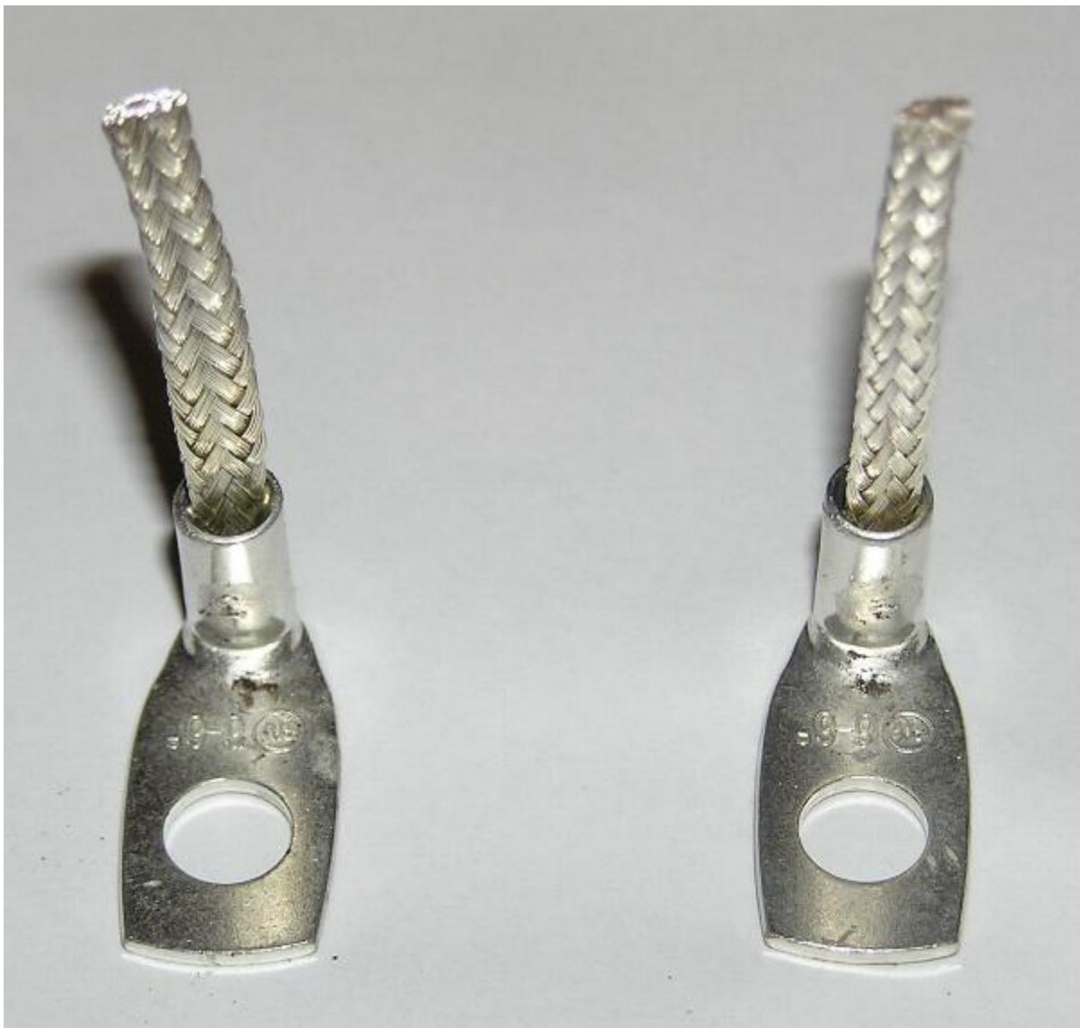
Nach den Abkühlen werden die Kabelschuhe in die oberen Löcher eingeschraubt. Dazu nimmt man die M6x30mm Schraube schiebt Kabelschuh mit eingelöteten Schirm, U-Scheibe und Gummidichtung drauf und steckt die Schraube von innen durch das Gehäuse.
