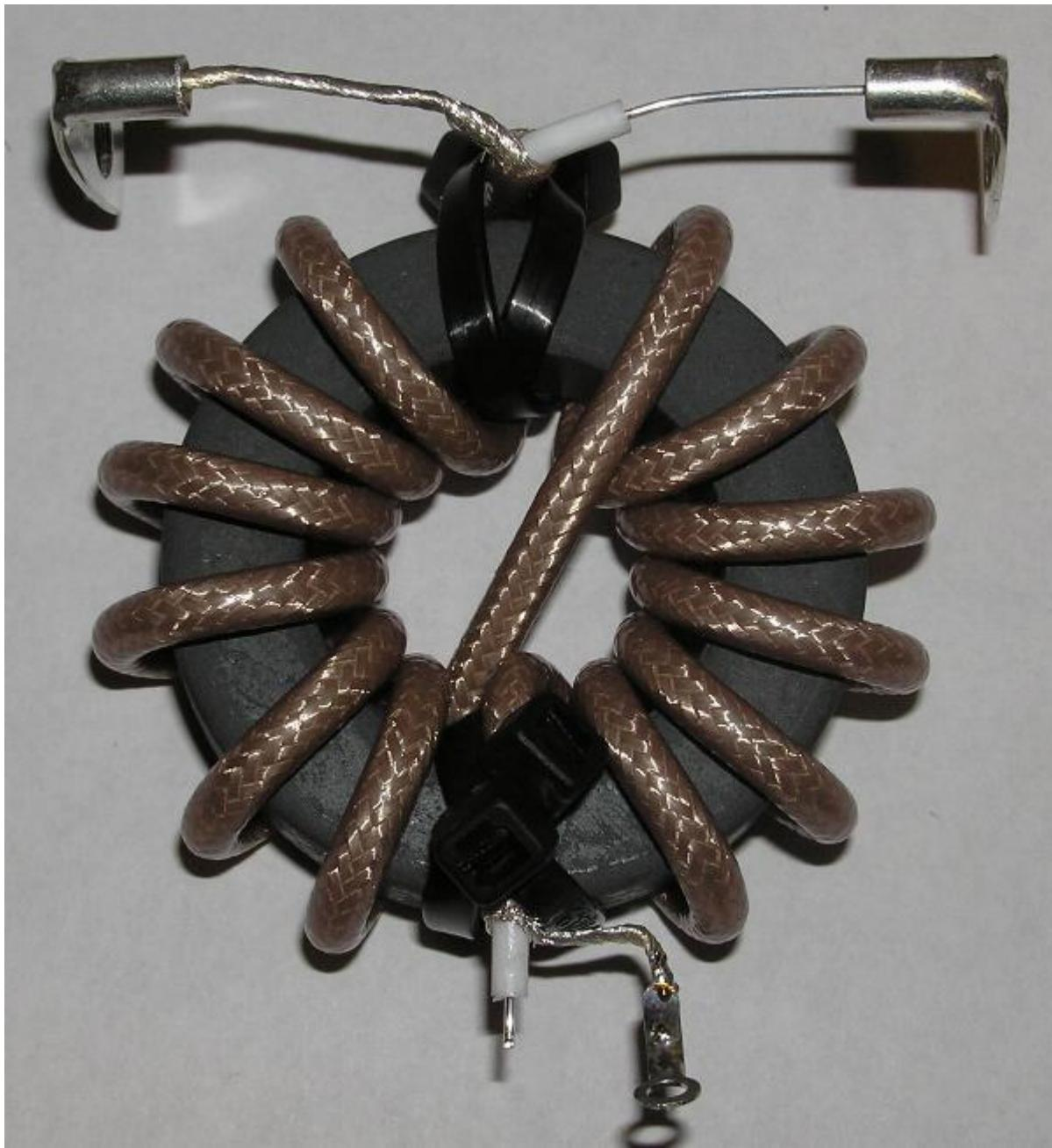
Am anderen Ende des Koaxkabels wird die Lötose an den Schirm gelötet. Nach den Abkühlen werden die Kabelschuhe in das Gehäuse eingeschraubt. Zuerst den rechten Kabelschuh mit dem Innenleiter. Dieser ist starr und wird deshalb als erster verschraubt.
