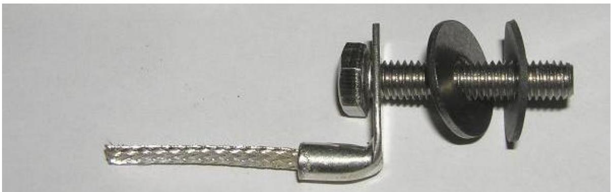
Von außen wird eine U-Scheibe und die Mutter aufgebracht. Jetzt die Schraube und Mutter mit zwei 10er-Schlüsseln ganz fest verschrauben. Dabei drauf achten, dass die Kabelschuhe mit dem angelöteten Schirm nach oben zeigen.
