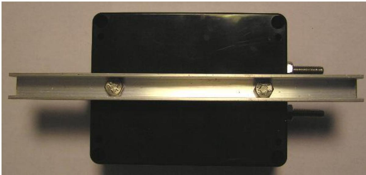
Von innen wird jeweils eine Gummidichtung, U-Scheibe und M6-Mutter aufgebracht und fest verschraubt.
