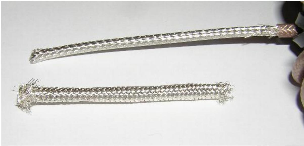
Dieses Stück Schirm wird zum weiteren Aufbau des Baluns noch gebraucht. Den inneren Schirm, wie schon am anderen Ende, aufspleißen, zusammendrehen und nach links biegen. Den Innenleiter ca. 10mm höher abisolieren und nach rechts biegen.
